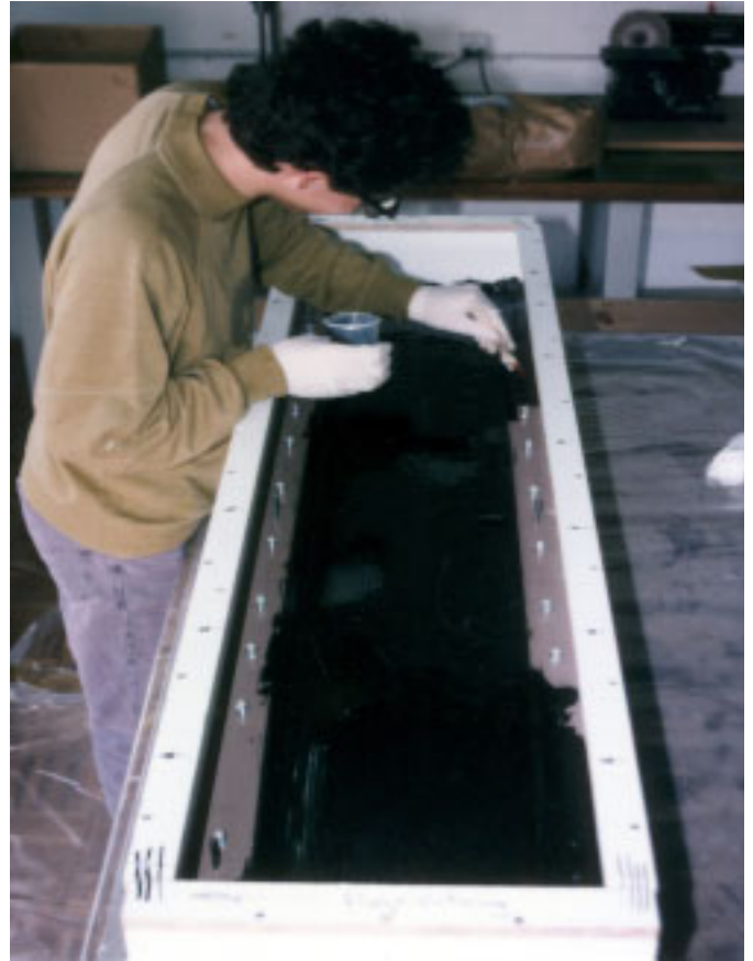
Bild 4: Nach dem Wachsen geht es wie üblich los: Das Epoxyd-Formenharz wird blasenfrei aufgestrichen. Hier ist darauf zu achten, daß alle Metallteile vollständig mit Formenharz bedeckt sind. Da die Laminierkeramik mit Wasser angerührt wird, würden sie sonst beim Aushärten rosten. Und rostige Passdübel lösen sich schlecht!
