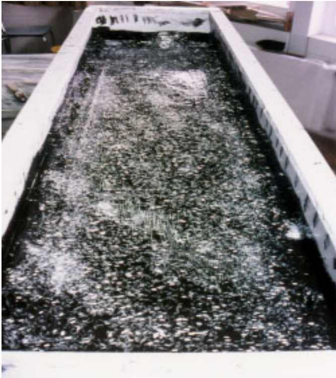
Bild 5: Um eine optimale Verbindung vom Formenharz mit der Kupplungsschicht zu erreichen, haben wir Glaschnitzel auf das Formenharz gestreut. Bei dünnen Formenharzschichten kann es allerdings geschehen, daß diese sich beim Tempern leicht abzeichnen. In solchen Fällen empfehlen wir Baumwollflocken für diese Aufgabe.
